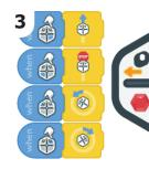
ルートのタッチセンサーに、 前に進む、左折に少し曲が る、右に少し曲がる、止まる 動きをプログラムします。
