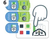
3つ目の"カラーセンサー"ブロックを追加し、緑色を選択します。左のゾーンだけが反応するように編集します。
